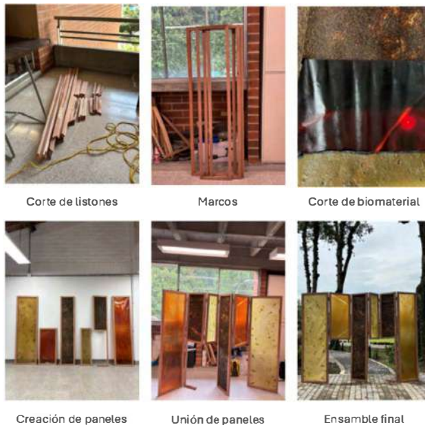
Figura 2. Proceso de creación y manufactura de BIOMbo.
