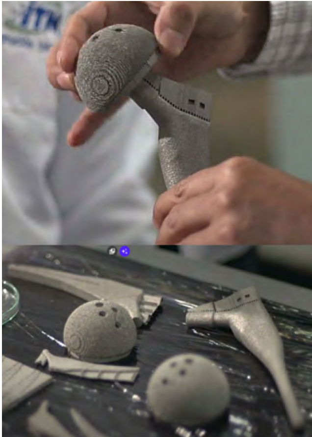
Figura 3. Vástagos y rótulas en Ti6Al4V con recubrimientos cerámicos para validaciones
