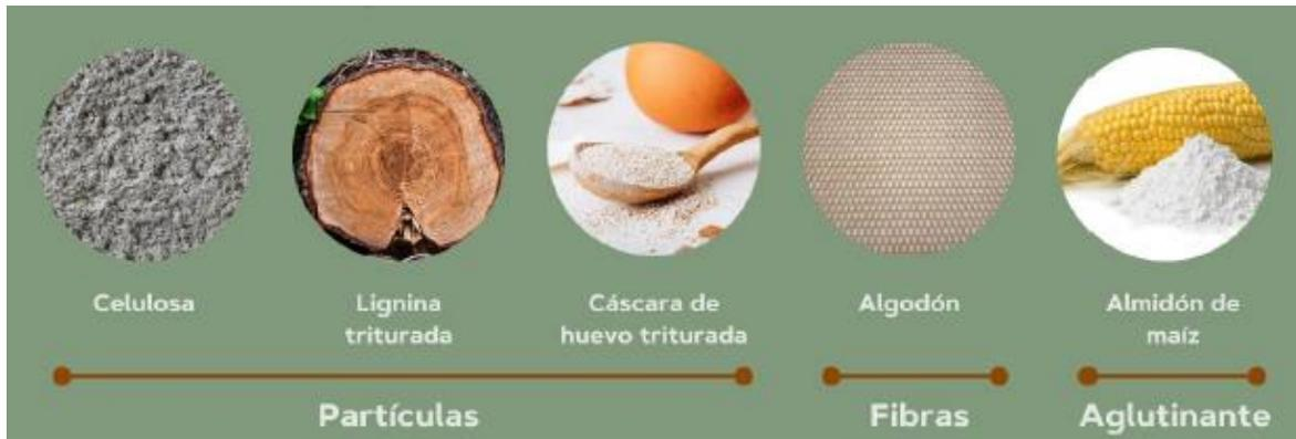
Figura 1. Materiales seleccionados para el diseño de los maceteros. Fuente: Propia.
