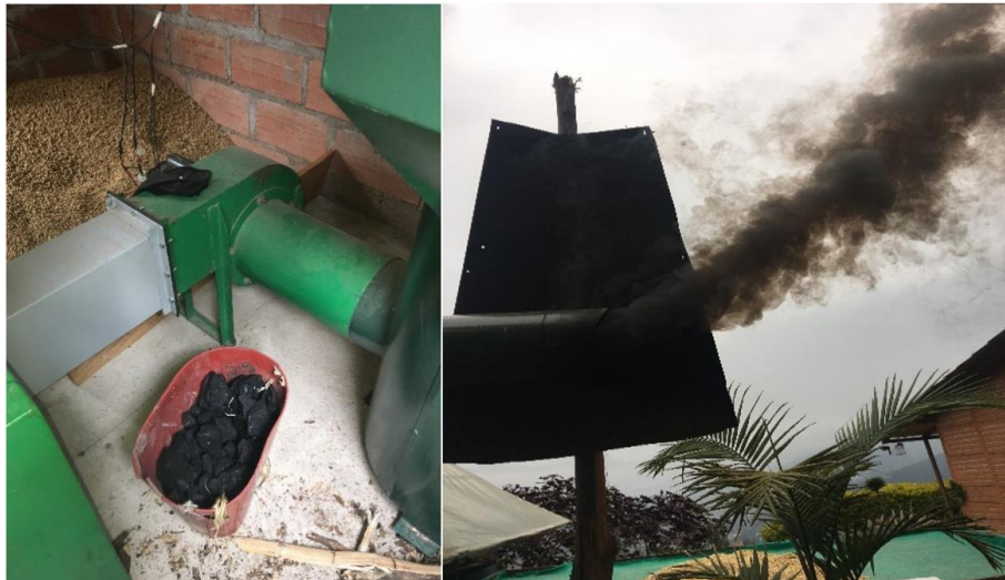
Figura 1. Secadora de café que opera con carbón. Izquierda: ventilador del quemador de carbón de y la secadora. Derecha: fumarola que sale de la chimenea de la secadora.
